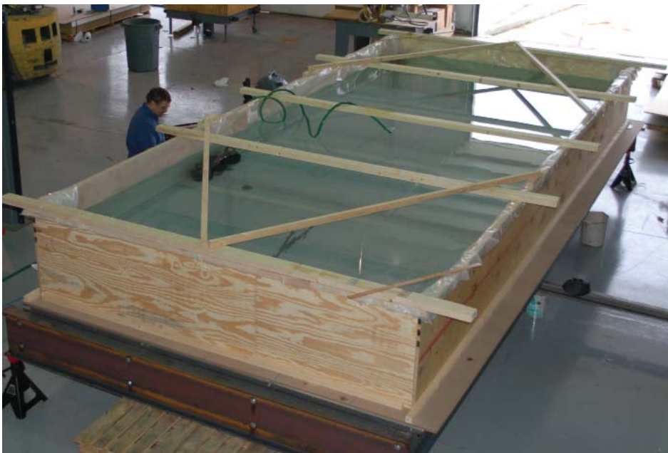
Cornerstone Specialty Wood Products recrea una condición de una carga uniformemente distribuida en una gran plataforma de prueba.
